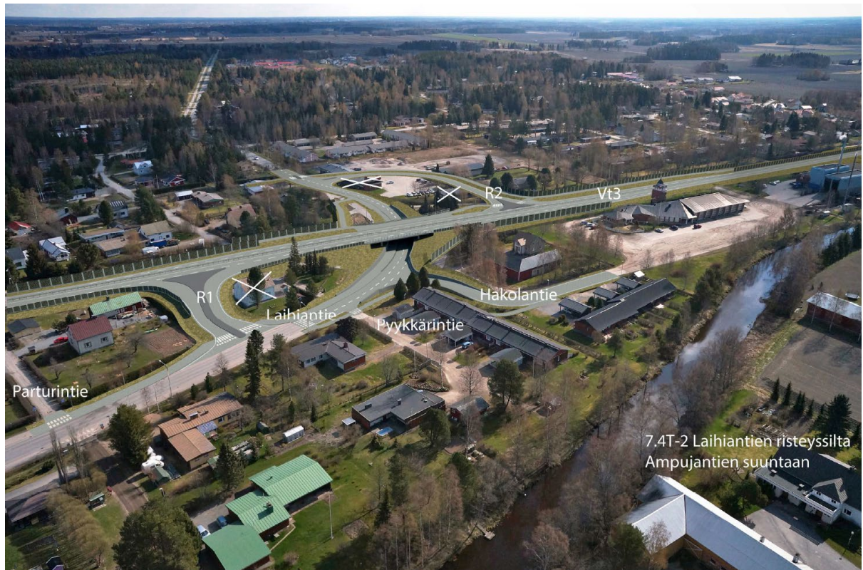
Kuva 22. Havainnekuva Laihiantien – Ampujantien eritasoliittymästä (Lähde: Tiesuunnitelman 28.11.2014 liiteaineisto).
