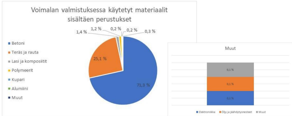
Kuva 63. Esimerkki voimalan valmistuksessa käytettävistä materiaaleista sisältäen voimalaperustukset ja niiden osuus koko voimalan massasta Voimalamalli Vestas V150-4,2 MW (Vestas 2022b)
